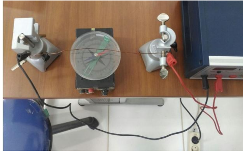
Gambar 10.1. Rangkaian peralatan praktikum Biot-Savart
