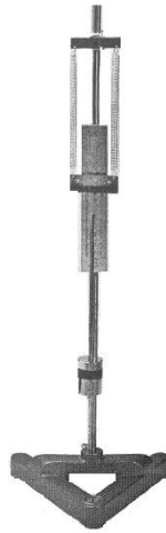
Gambar 4.2. Rangkaian praktikum hukum hooke.
